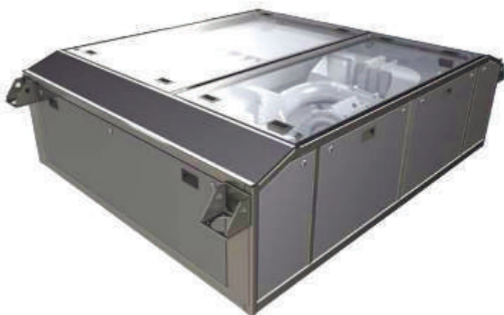
Рис. 26. Воздушная климатическая система (ВКС) для железнодорожных вагонов
