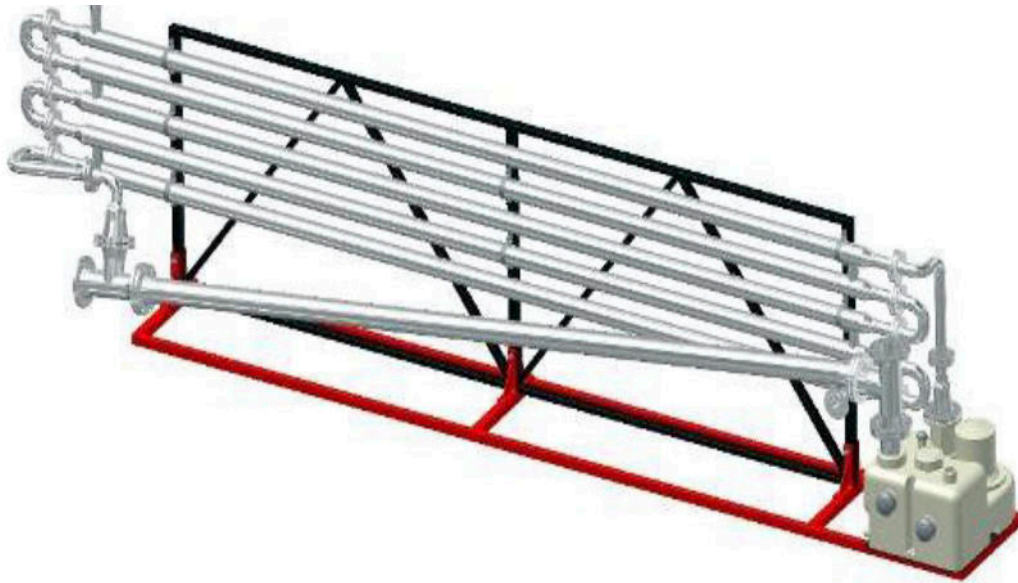
Рисунок 6.32. Внешний вид варианта моноблочной компоновки утилизатора с побудителем циркуляции и выпуском-байпасом
